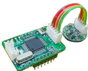
Рисунок 10. Пример платы с микроконтроллером для сопряжения сенсоров компании City Technology с газоаналитическим оборудованием.
